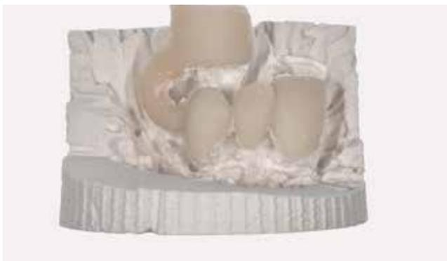
Apenas um sprue para uma ponte de três elementos. Camada de reação mínima, jato de areia simples, sem necessidade de usar ácidos tóxicos.
